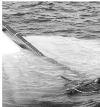
Fasta skot vid sidvind kan segla in vatten och båten lägger sig på sida.
