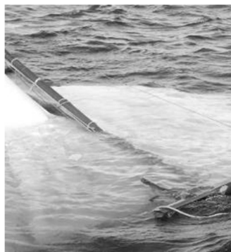
Fasta skot vid sidvind kan segla in vatten och båten lägger sig på sida.
